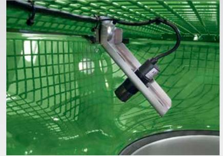
✓ Capteur de trémie vide sur le ZA-TS
